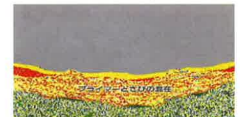
③ さび層との混在(メンテナンスをしない場合)
